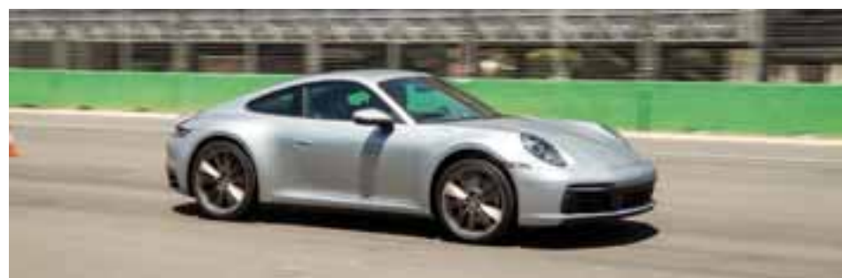
El peso ha sido minimizado gracias al uso extensivo de aluminio para la carrocería. | FOTOS: PORSCHE
