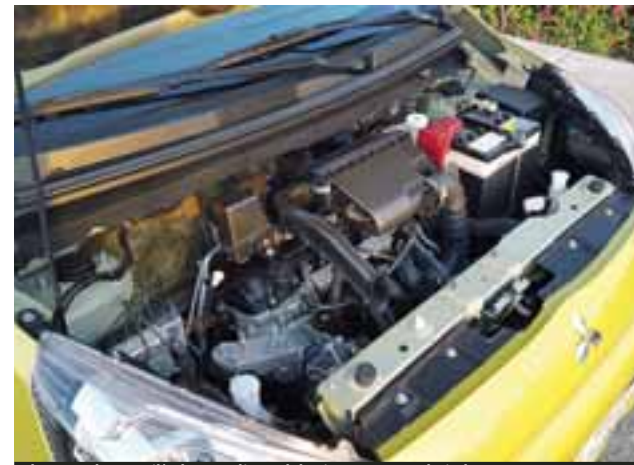
El motor de tres cilindros 1.2 litros del Mirage es su as bajo la manga. / MARIO ROSSI
