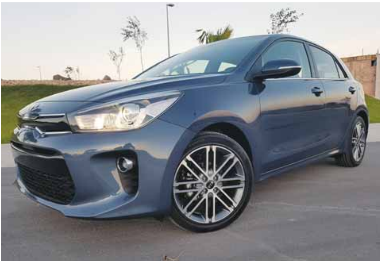
Los faros tienen regulación interna de carga y éstos proyectan la luz de forma precisa y de manera importante. La parrilla ahora adelgazó y la entrada de aire se encuentra en la parte baja. |MR
